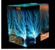
A photograph of a Lichtenberg figure, a branching fractal pattern created by electrical discharges in a resin block. | Su forma y crecimiento parecen estar relacionados con el proceso de agregación por difusión limitada (Cf Sapoval). |
